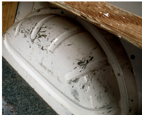
Nutzungsbedingter Abrieb und Kratzer
