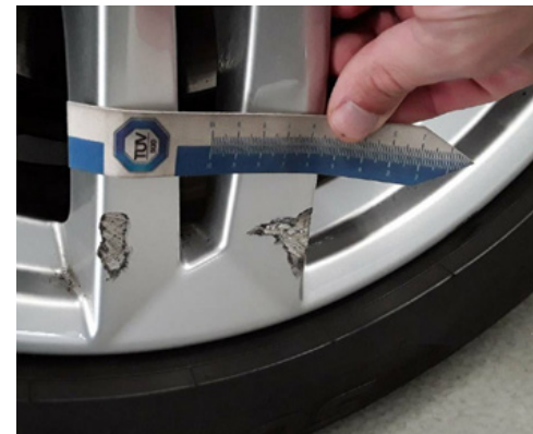
Beschädigung Felge mit Materialabtragung
