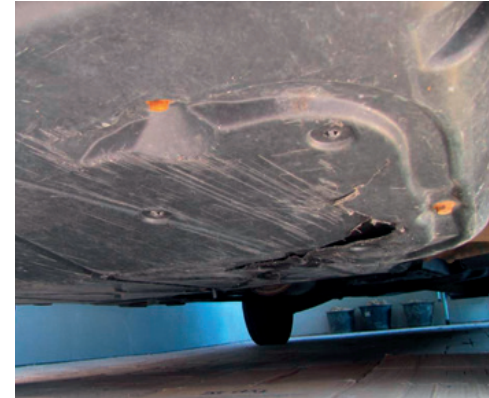
Beschädigung der Unterbodenverkleidung
