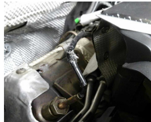
Beschädigung durch Nagetiere
