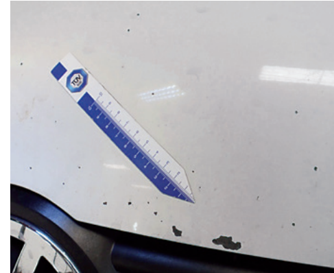
Mehr als fünf Steinschläge pro 10 \times 10 cm
