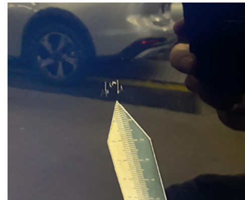
Beschädigung des Basislacks
