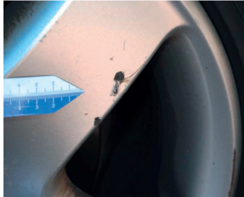
Leichte Kratzer ohne Materialabtragung
